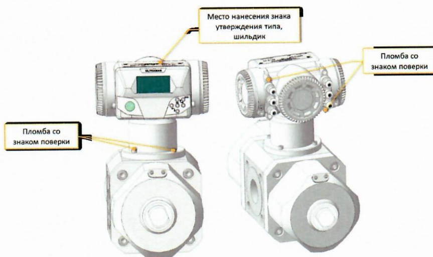
Рисунок 8 – Схема пломбировки комплекса исполнения RT, указание места нанесения знака утверждения типа, расположение шильдика
